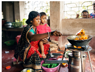
Indien: Effiziente Holzvergaseröfen
